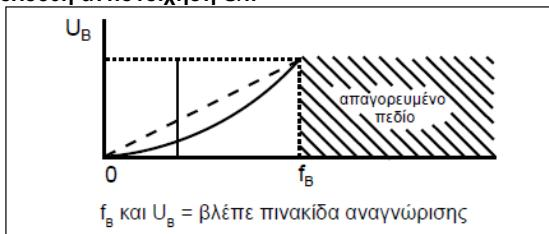
Σε περίπτωση μη τήρησης το ρεύμα του κινητήρα αυξάνεται αντιστρόφως ανάλογα και η κινητήρια μηχανή δεν επιτυγχάνει τον ονομαστικό αριθμό στροφών.
